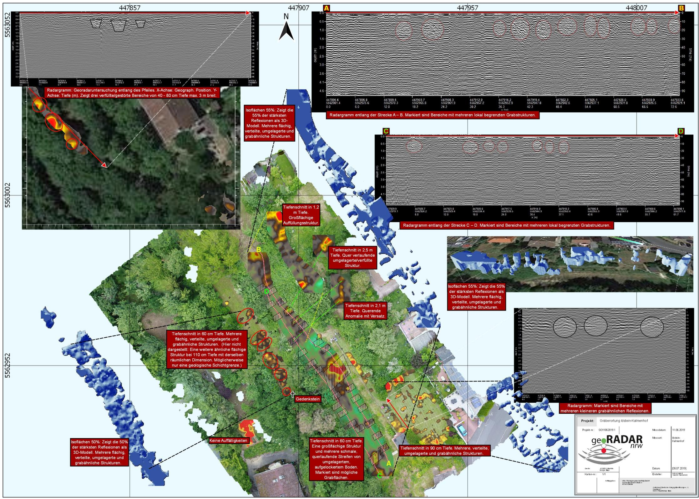
Radargramm: Georadaruntersuchung entlang des Pfeiles. X-Achse: Geograph. Position. Y-Achse: Tiefe (m). Zeigt drei verfüllte/gestörte Bereiche von 40 - 80 cm Tiefe max. 3 m breit.
